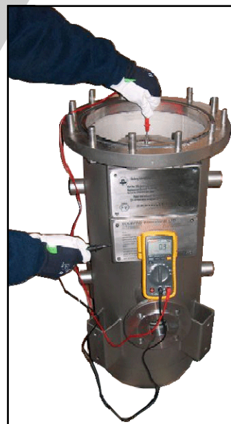
Проверка проводимости корпуса фильтра
